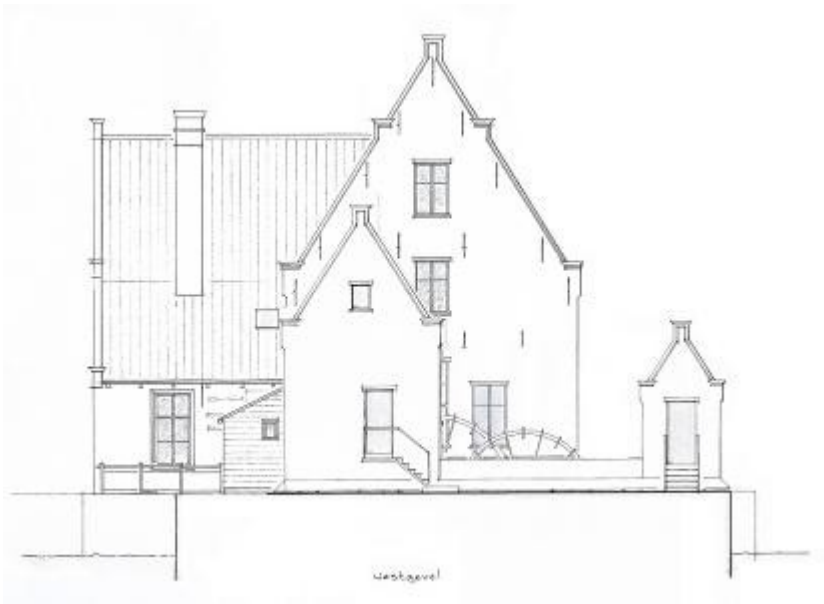
Afb.27a, b en c. Ontwerp voor de reconstructie van de waterwerken, 2009.
